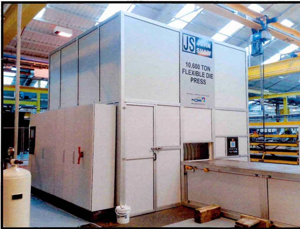
Figure 18: On site - 10600 Ton Rubber Die Press
