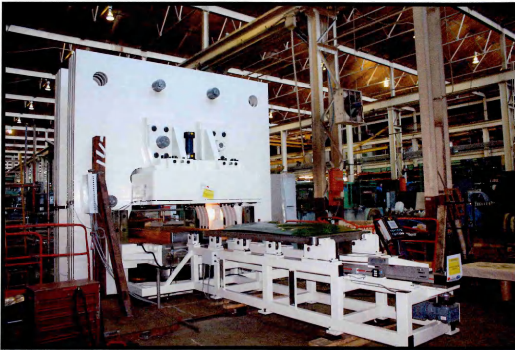
Figure 17: Testing of 10600 Ton Rubber Die Press
